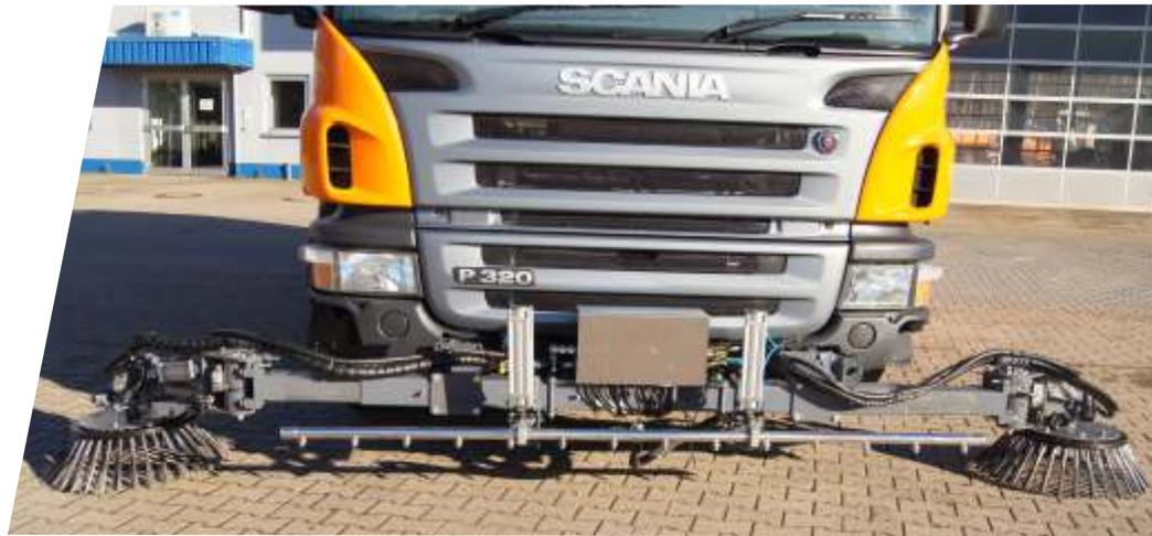
Unser seitlicher Frontbesen ist sowohl als einfache als auch als beidseitige Variante lieferbar. Die Besen sind über Drehmotoren stufenlos ausschwenkbar und über Hydraulikzylinder ausziehbar und in 2 Achsen in der Neigung verstellbar. Der Anpressdruck und die Besendrehzahl ist stufenlos einstellbar. Je nach Fahrgestell können die Besen vorne unter- oder vorgebaut werden.
