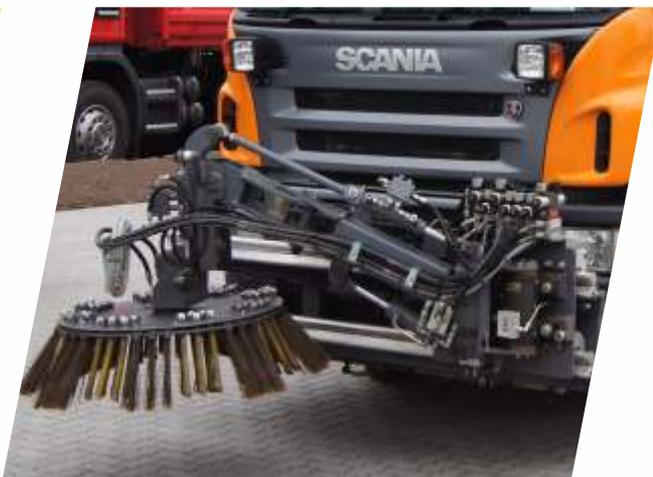
Für besonders schweren Einsatz im Wildkraut bieten wir eine enorm Leistungsfähige Lösung an. Der große Frontbesen ist voll über die Fahrzeugbreite verschiebbar, kann stufenlos über einen Drehmotor links und rechts geschwenkt werden und lässt sich in 2 Achsen in der Neigung verstellen. Der Anpressdruck sowie die Besendrehzahl lassen sich in beide Richtungen stufenlos regeln.
